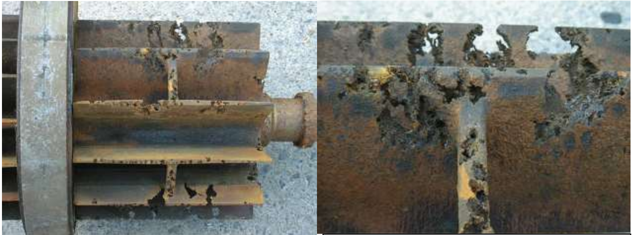
Bild 9. Kavitations-skador på vakuumpumphjul
