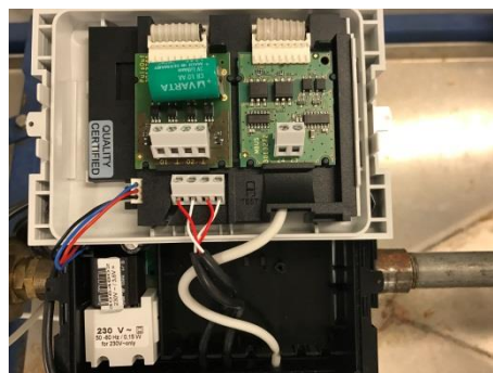
Fig. 7: Anslutningsexempel på temperaturgivare med tvåledar-teknik
