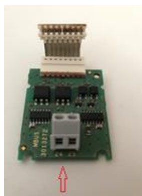
Figur 10: Anslutning plint 24,25 på M-Buskort
